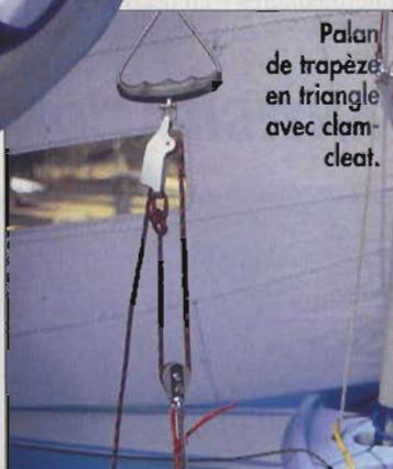
Palan de trapèze en triangle avec clam-cleat.
