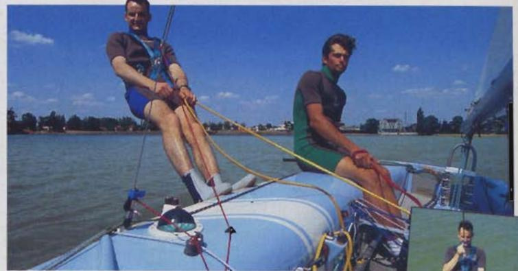
**4. Réglez la hauteur de votre cuillère** (boucle de trapèze) au moyen du petit palan. Votre efficacité au trapèze en dépend. C'est bien allongé dans le plan du bateau que vous obtiendrez un couple de rappel maximal.
